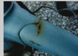
Haarrisse bereits rostig
